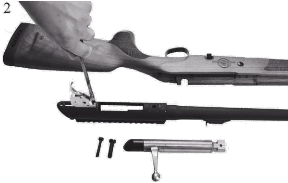
Рисунок 12 – Разборка ружья «Таёжник», ВПО-223.00.00
